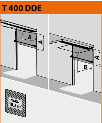
Système de rails levée semi-verticale avec axe de ressort surbaissé A= élévation + 200 mm, B= hauteur du jour – élévation + 600 mm Largeur max. 3.200 mm Hauteur max. 3.200 mm Élévation min. 1.700 mm
