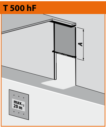
Système de rails vertical avec axe de ressort surbaissé + profilé de support en acier A= hauteur du jour + 400 mm, B= non applicable Largeur est max. 4.500 mm
